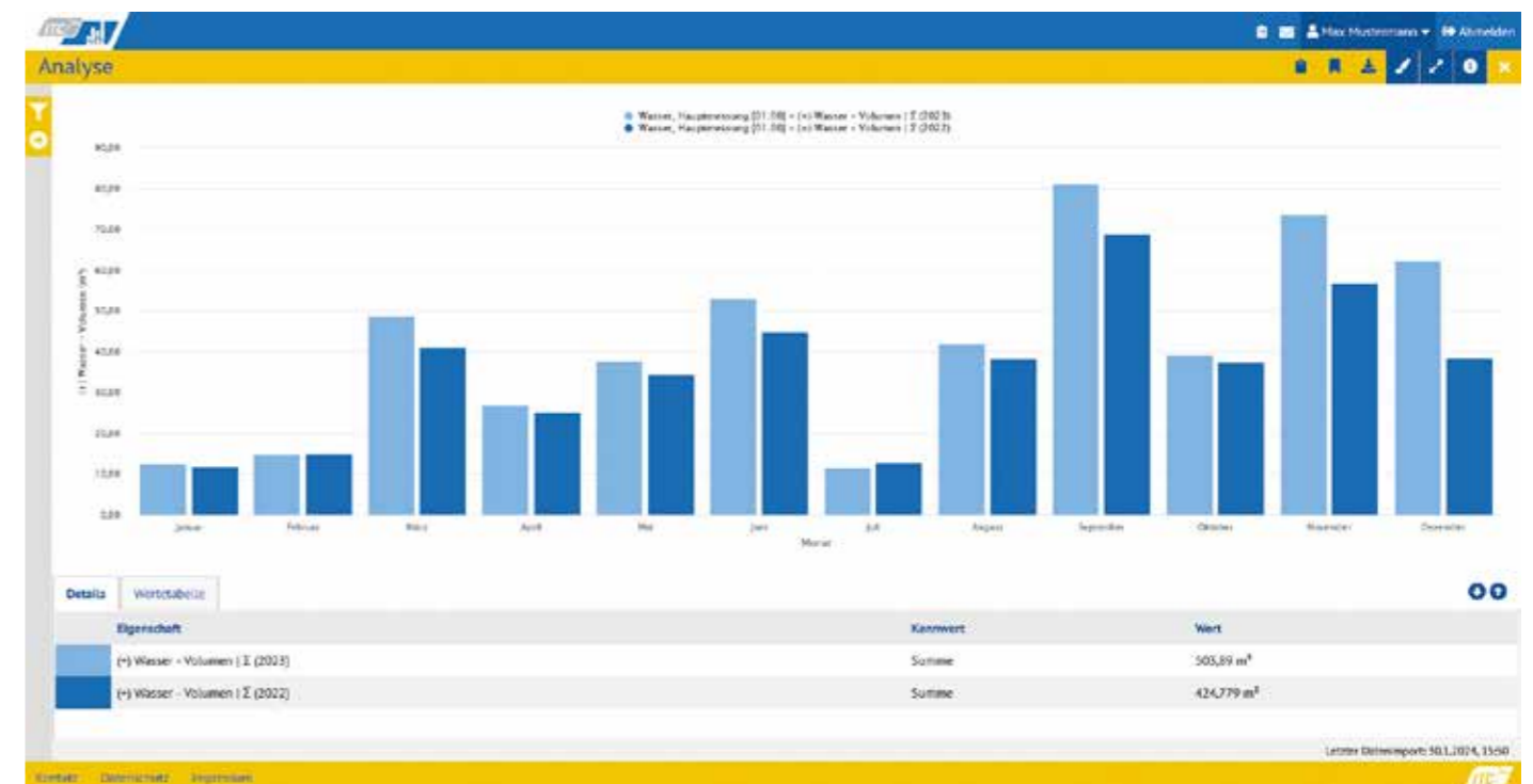
Bild 2 Die Energiemanagementsoftware ITC PowerCommerce EnMS ermöglicht es, erfasste Energie- und Umweltdaten zu aggregieren und flexibel auszuwerten. Auch Vergleiche mit Vorperioden, anderen Sensoren oder Zählergruppen sind möglich. Anhand der Visualisierung lassen sich Optimierungsansätze identifizieren.
